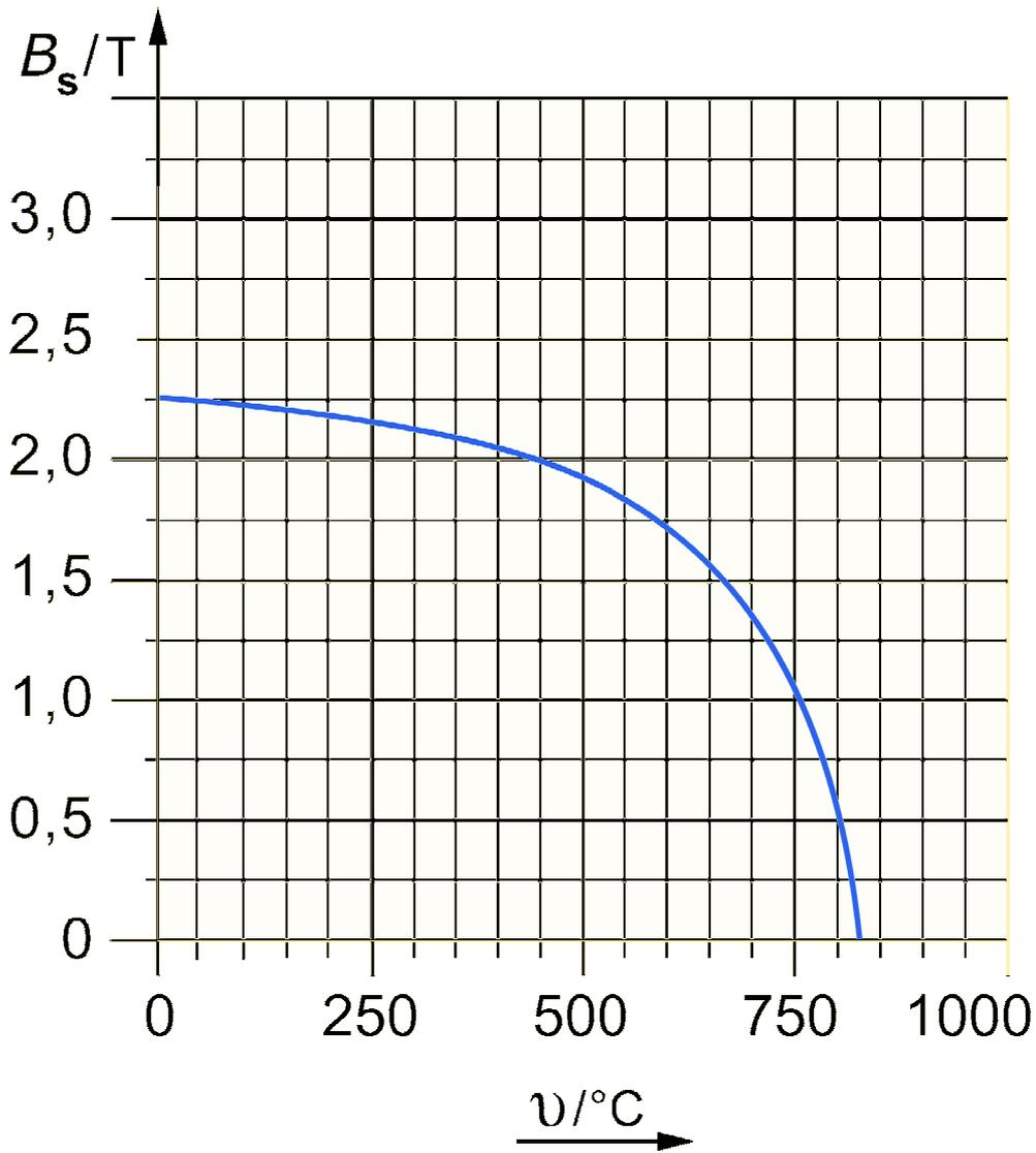
Abhängigkeit der Sättigungsflussdichte  $B_s$  von der Temperatur bei reinem Eisen.
